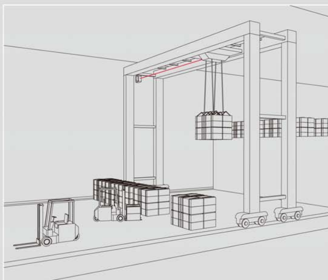
通过FR92测距传感器实现吊车定位
