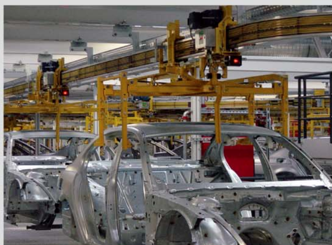
汽车工业中的高架台车输送系统
