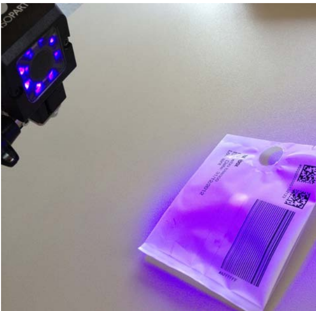
集成了波长400nm的UV紫外光源的读码器
