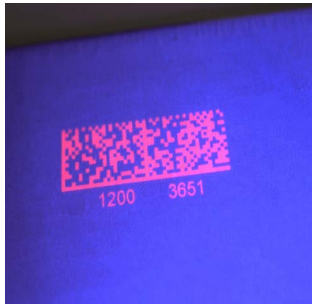
荧光码被波长为400nm的光照射时反射出红光
